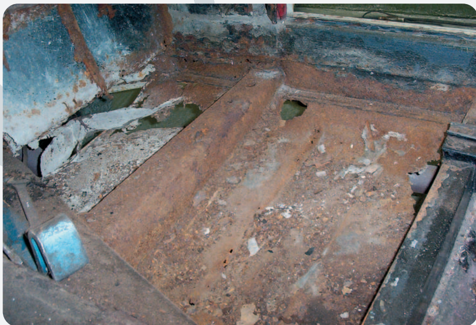
Corrosión habitual en el piso de la carrocería.
